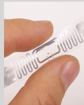
Identification par fréquence radio (RFID)
