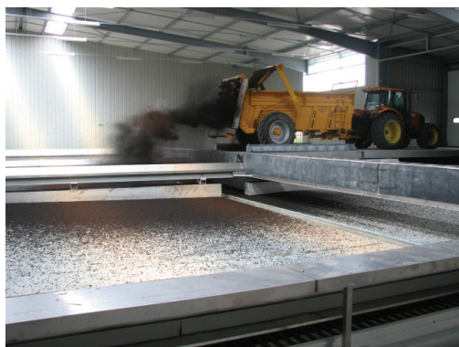
Banc de recherche et d'essais CEMOB pour l'évaluation des performances des machines d'épandage d'engrais organiques
